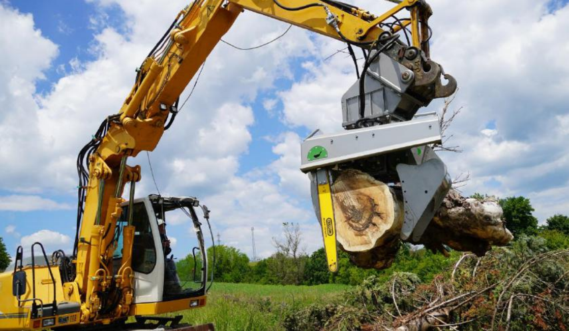
Entfernen beschädigter Bäume mit dem Modularis Forst-Kombiwerkzeug (Holzgreifer + Sägebalkenmodul)
