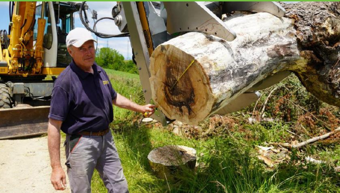
Sägen und Entfernen umgestürzter Bäume nach Windbrüchen und Stürmen mit dem Modularis Forst-Kombigreifer (Holz-/Baumscherengreifer + Modularis-Sägemodul)
