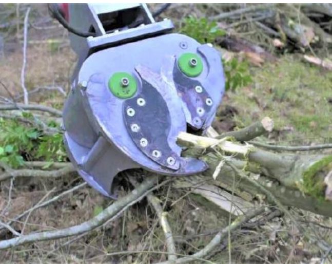
„Leaking Free“ geschlossener Antrieb ohne austretendes Hydrauliköl für wasserdichte Bereiche
