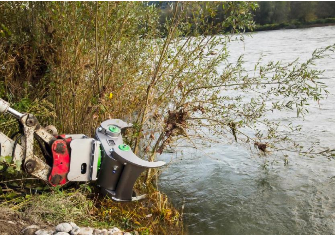
„Leaking Free“ geschlossener Antrieb ohne austretendes Hydrauliköl für wasserdichte Bereiche
