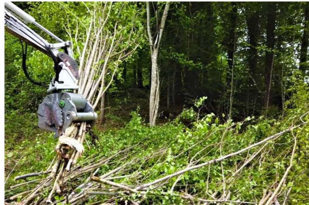
Das Modularis-Baumscherenwerkzeug benötigt keinen Sammler, für mehrfachen Schneiden
