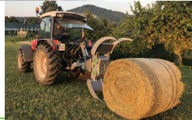
Biomasse-, Ballen- und Trockenheugreifer für die 3-Punkt-Heckneigungsverbindung des Traktors mit 360-Grad-Drehung
